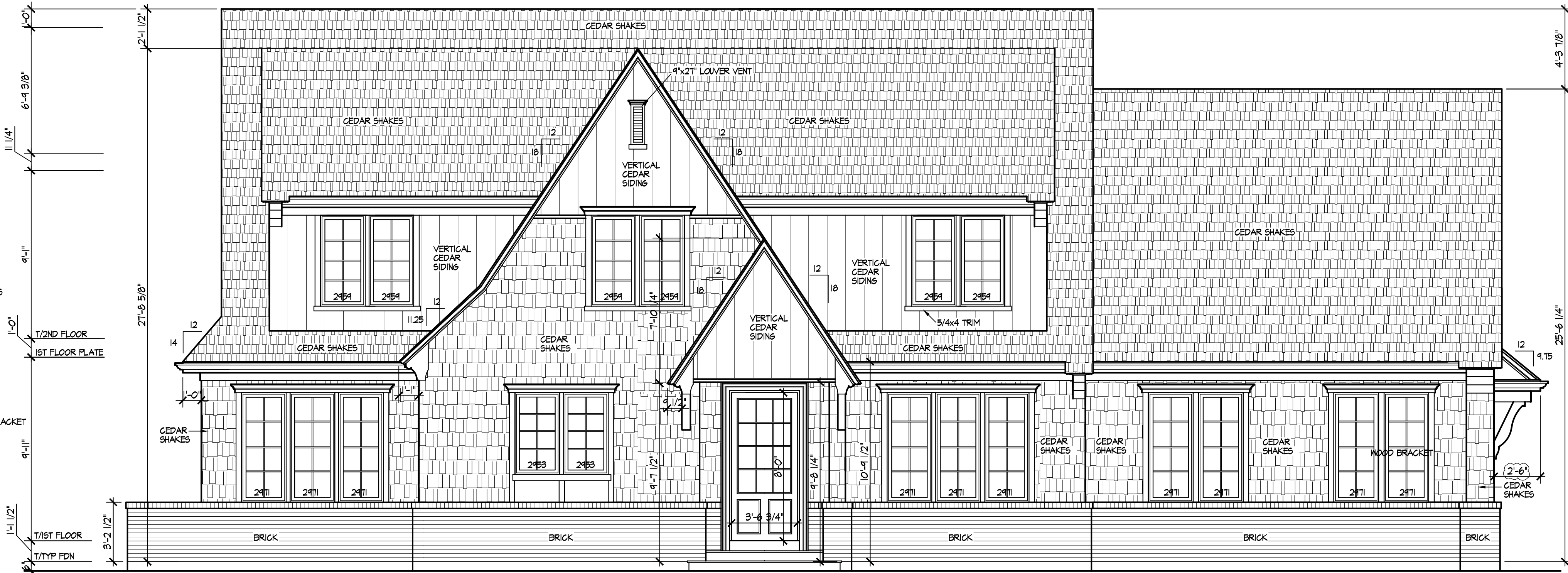
900 N. VAIL FRONT ELEVATION SCALE: 1/4"=1'-0"
