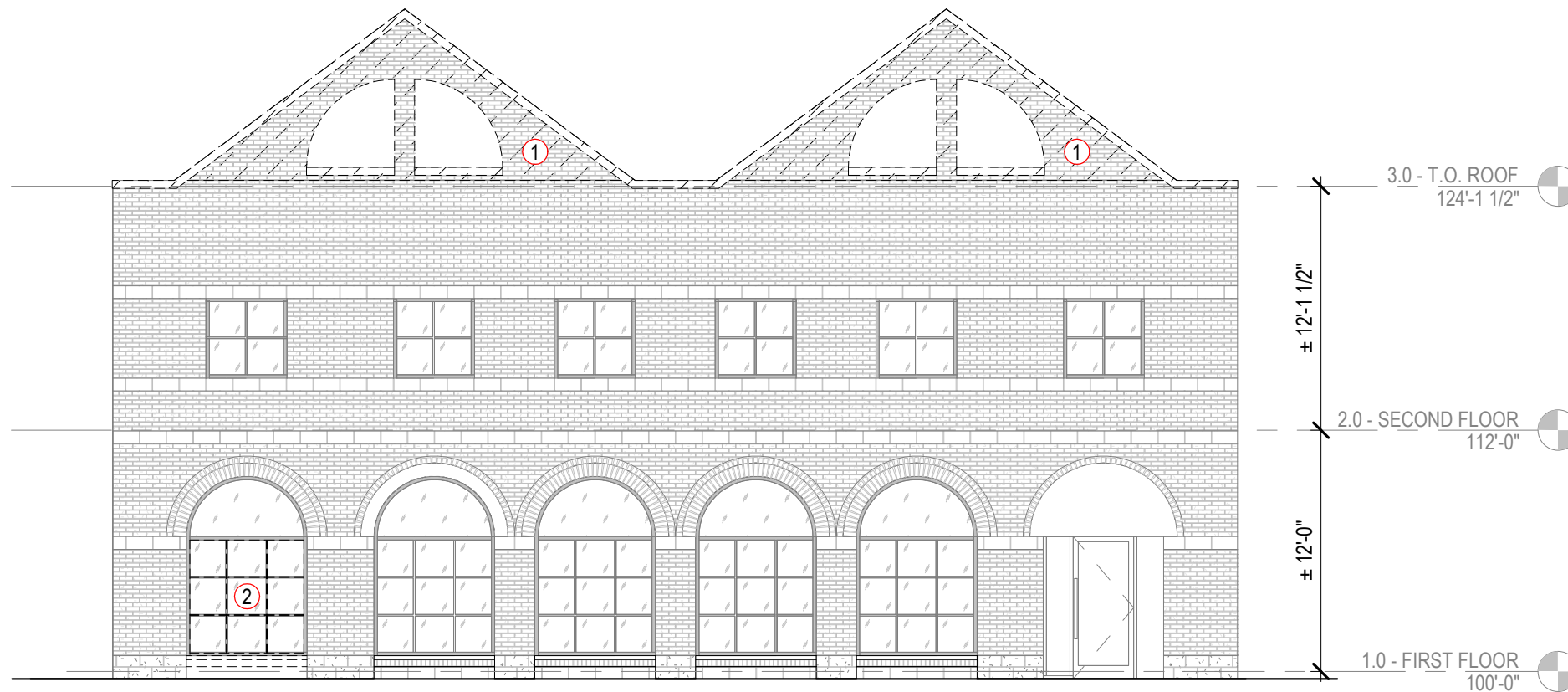
1 EXISTING / DEMOLITION ELEVATION - N. VAIL AVE. 1/8" = 1'-0"
