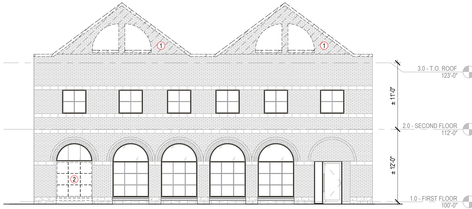
1 EXISTING / DEMOLITION ELEVATION - N. VAIL AVE. 1/8" = 1'-0"
